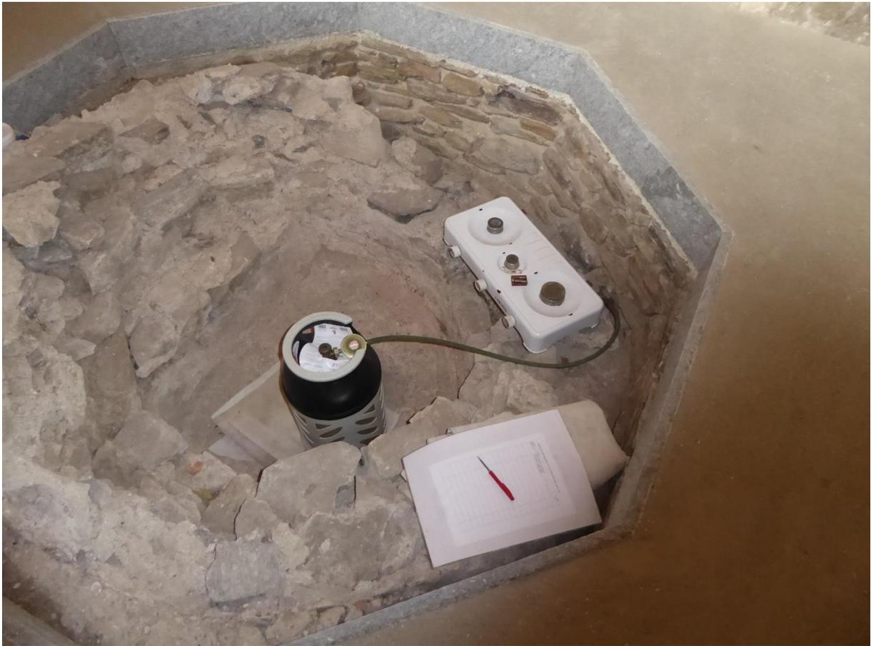
Die Gasheizung hält die Temperatur im Raum deutlich über null Grad Celsius und musste wöchentlich kontrolliert werden, damit die Karbonatisierung stattfindet (Bei Frost entstünde Totschaden)
